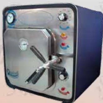
Autoclave Quadrant para esterilizar con parámetros 121°C. y 20 PSI E-015R
